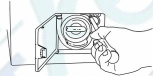
• Установите кольцо в предназначенный для него паз и завинчивая, установите его на место. Закройте дверцу сливного насоса. Если и после этого дверца не откроется, то обратитесь в сервисную службу.
