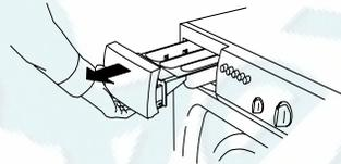
Сполосните и помойте щеткой отделения емкости для моющего средства и прополаскивателя для того, чтобы удалить все остатки моющих средств с внутренней поверхности и стенок емкости. Установите емкость на место.
